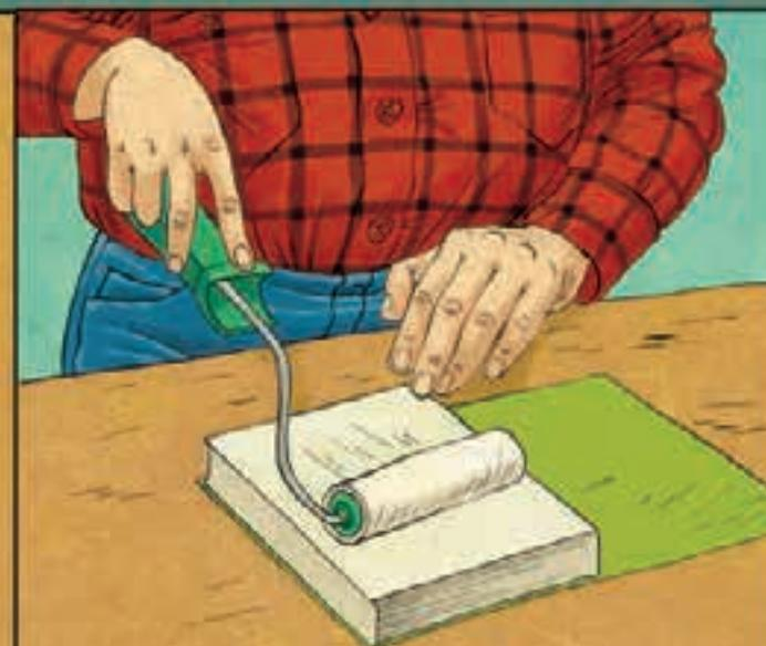
На обложку кладем блок и наносим клей на форзац
