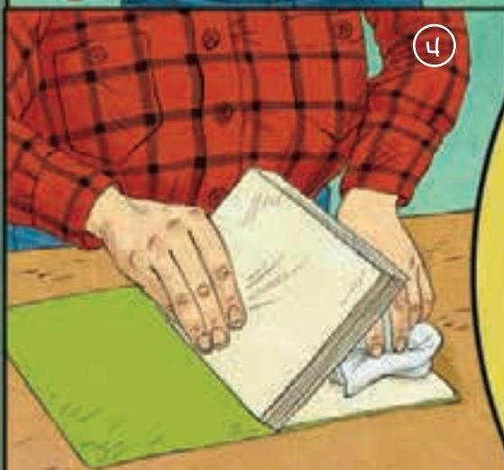
Выравниваем блок на обложке и прижимаем форзац к обложке
