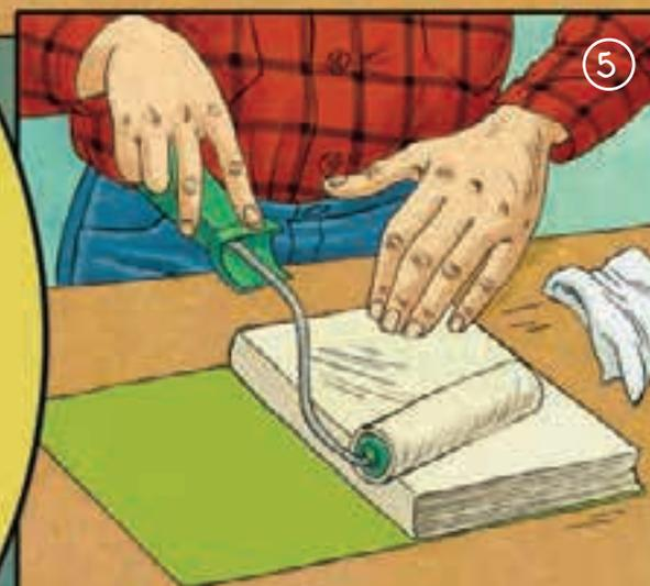
Разворачиваем наше изделие другой стороной, и так же наносим клей на нахзац
